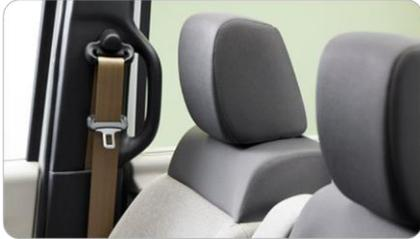
後方から低速で追突された際に、首への負担を軽減する頸部衝撃緩和シートを運転席/助手席に採用しています。
